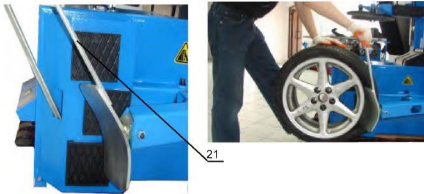
Rys. 6. Odpikanie opony 21 - dźwignia odpiętkacza
