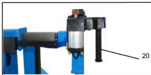
Rys. 5 Widok głowicy roboczej 20 - pokrętło blokady suwadła
