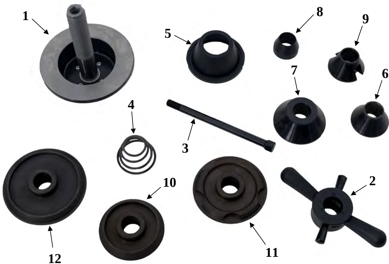
Rysunek 4: Elementy uchwyty: 1: nasada z flanszą 2: nakrętka dociskowa 3: śruba do mocowania nasady na wrzecionie 4: sprężyna 5: docisk nakrętki 6: stożek centrujący nr 1 7: stożek centrujący nr 2 8: stożek centrujący nr 3* 9: stożek centrujący nr 4* 10: stożek centrujący nr 5 (110mm-125mm)* 11: stożek centrujący nr 6 (125mm-145mm)*, 12: stożek centrujący nr 7 (145mm-165mm)* * - wyposażenie dodatkowe
