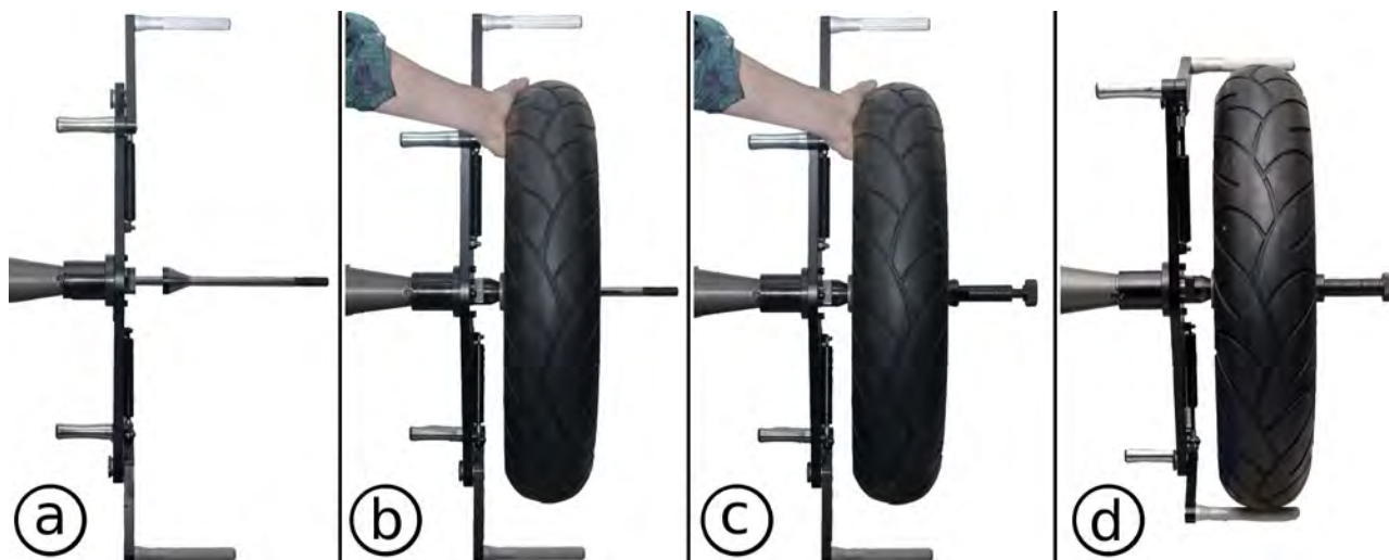
Rysunek 14: Mocowanie koła motocyklowego w uchwycie.
