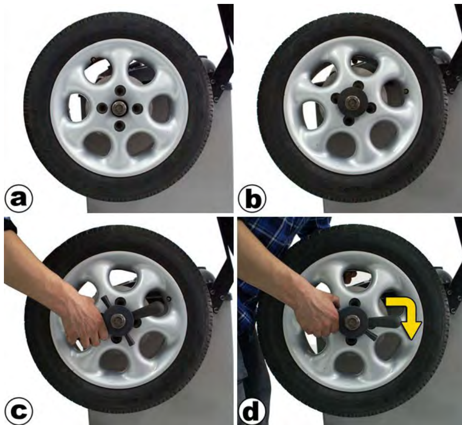
Rysunek 8: Mocowanie koła w uchwycie wyważarki
