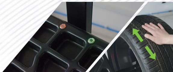
Для навигации курсором в меню используется колесо. Вращая его в одну или другую сторону, выбираются функции, которые затем подтверждаются зеленой кнопкой. Для выхода из функции нажимается красная кнопка
