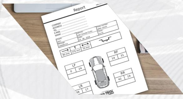
Машина оснащена функцией генерации отчетов, которые можно создать после завершения балансировки колес. Благодаря встроенному USB-разъему отчет можно сохранить в формате PDF на подключенном накопителе или распечатать прямо с устройства при наличии подходящего принтера
