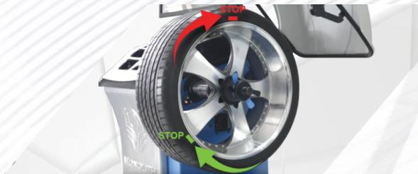
Балансировочный станок оснащен системой автоматического позиционирования колеса в точке приклеивания или установки груза
